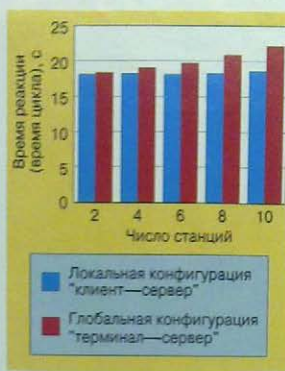
Рис. 5. Зависимость времени реакции системы от числа одновременно работающих станций.
