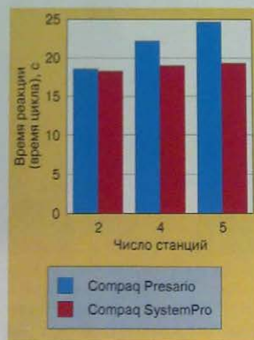
Рис. 6. Зависимость времени реакции системы от типа компьютера, используемого в качестве сервера приложений.
