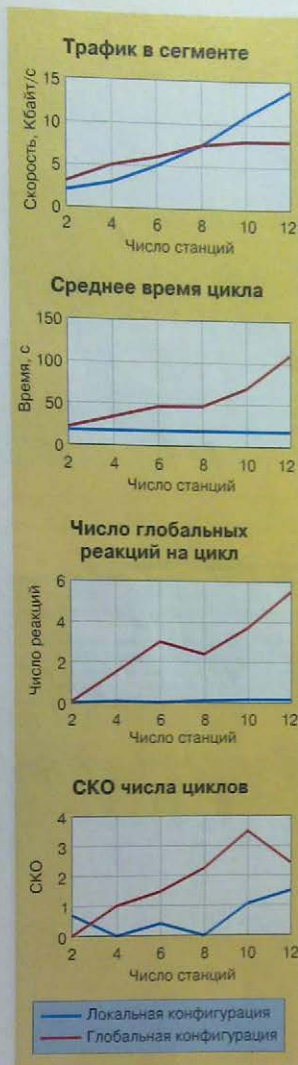
Рис.4. Результаты работы пакета RS-Bank в различных сетевых конфигурациях.
